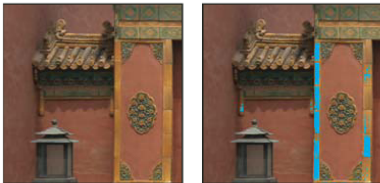
Imaginea inițială și previzualizarea culorilor din afara gamei reproductibile, albastru fiind selectat drept culoare de avertizare pentru gama reproductibilă
